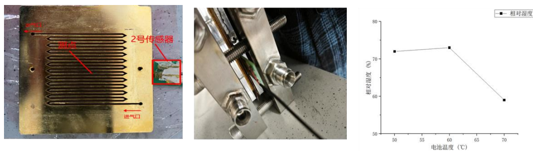
(a) 测点位置 (b) 传感器安装 (c) 湿度值
