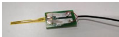
图 4 焊上铜丝导线的传感器
