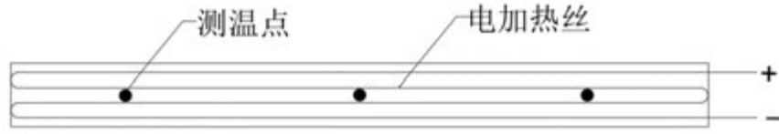
图 0 加热带内电加热丝的布置情况
